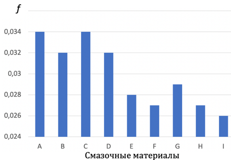
Рисунок – 5.6. Среднее значение расчетного коэффициента трения: А – без смазочного материала, В – моторное масло, С – моторное масло + 0,1 % C_{60} , D – моторное масло + 0,2 % C_{60} , E – моторное масло + 1 % C_{60} , F – моторное масло + 2% C_{60} , G – моторное масло + 0,1 % УНТ, H – моторное масло + 0,2 % УНТ, I – моторное масло + 1 % УНТ
